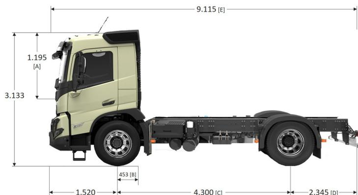
[A] Altura libre sobre túnel de motor. [B] Ancho desde centro de eje direccional a final de chapa de cabina. [C] Distancia entre ejes. [D] Largo voladizo trasero. [E] Largo total (variable según [C/D]). Todas las medidas son de referencia, para mayor detalle consultar con Ingeniería de Ventas.
